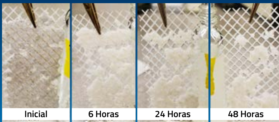
Pruebas de laboratorio del desintegrador de incrustaciones de sulfato de calcio, AWC C-238.
