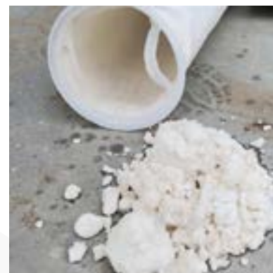
Incrustación de yeso desintegrada recolectada en los filtros de bolsa.
