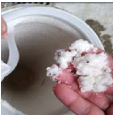
Incrustación de yeso desintegrada recolectada en los filtros de bolsa.
