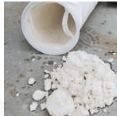
Incrustação de gesso desintegrado coletada nos filtros de mangas.
