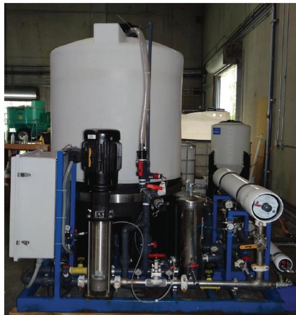
El desempeño de la membrana se evalúa utilizando un tren de prueba de un solo elemento en cada etapa del estudio de limpieza.
